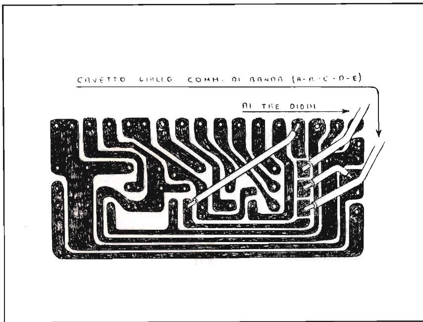
Figura 3. Basetta deviatori modificata.
